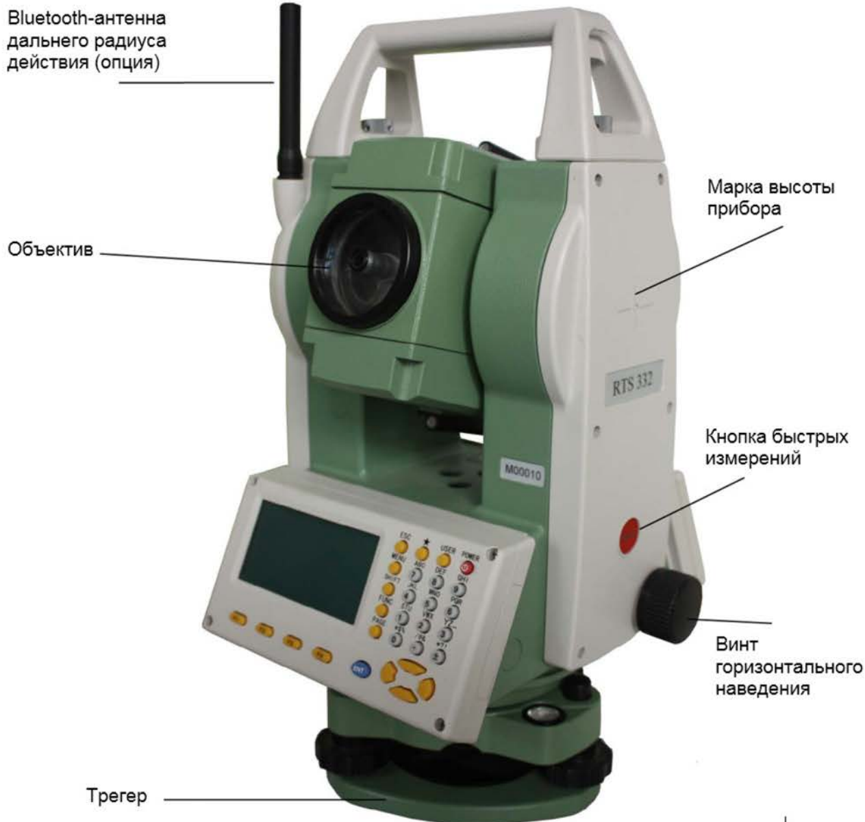
Рисунок 4 - Основные элементы тахеометра RTS332 (передняя часть)
