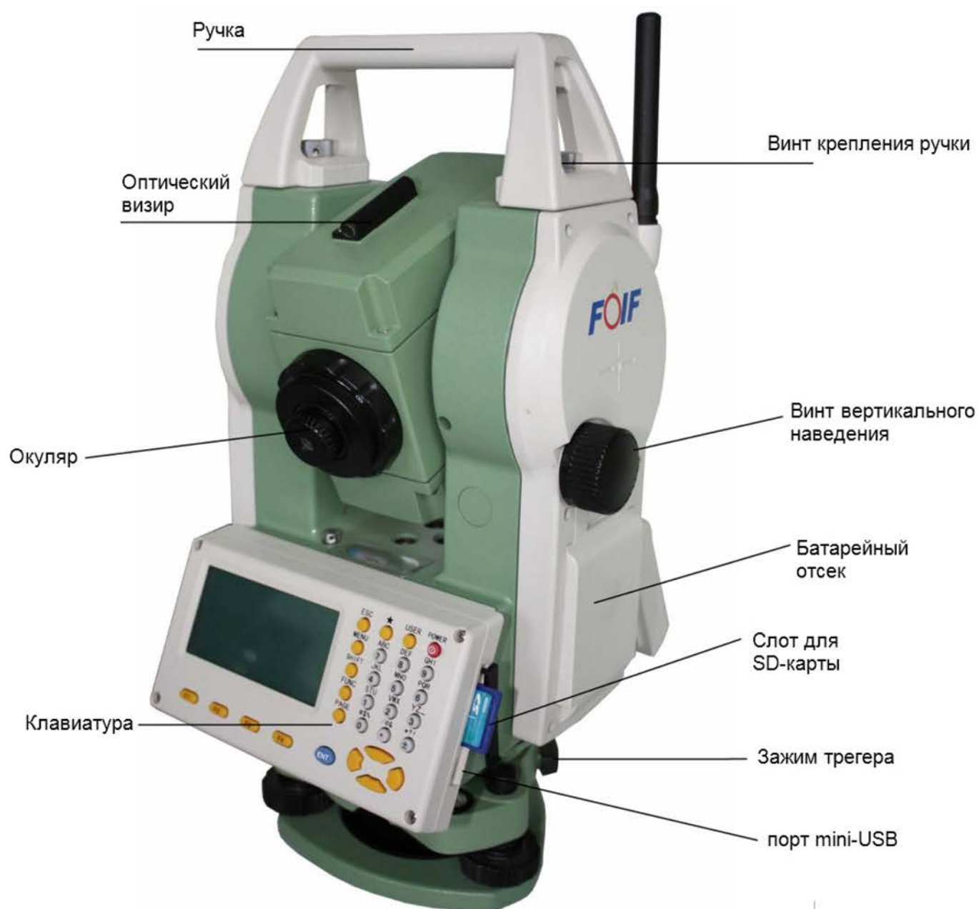
Рисунок 3 - Основные элементы тахеометра RTS332 (задняя часть)
